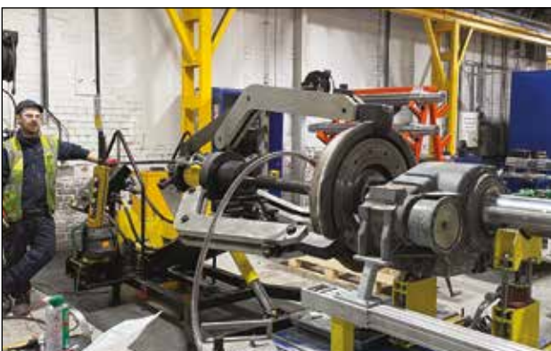
◀ LGH3100:lla poistetaan kiskopyörä akselilta.
